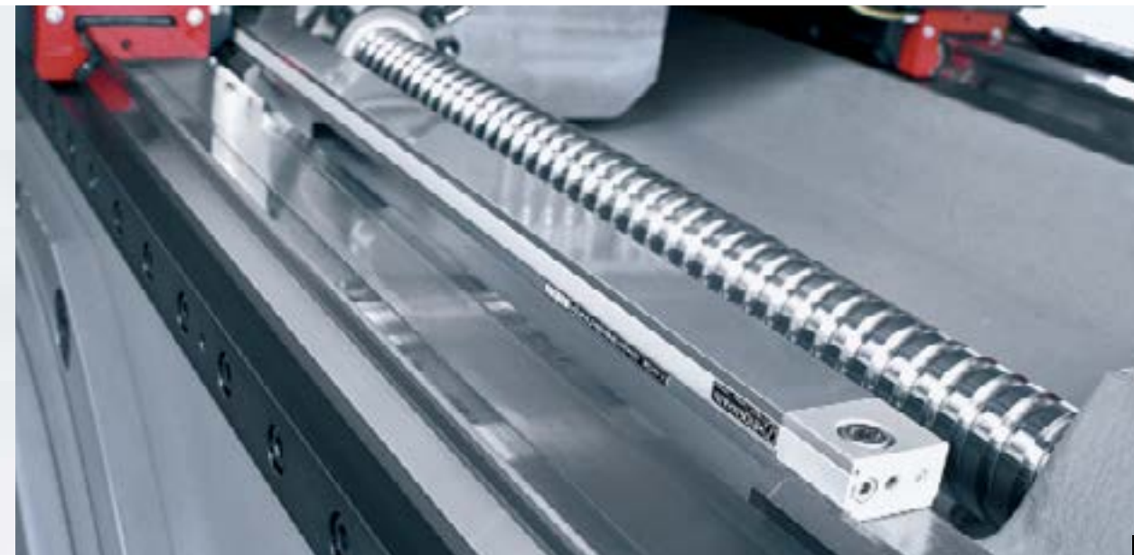
1: Цифровые приводы, линейные направляющие и системы прямых измерений (опция) обеспечивают высокую точность 2: Неподвижный стол 3: Наклонно - поворотный стол с цифровыми приводами 4: Поворотный стол с 5-осевой одновременной обработкой
