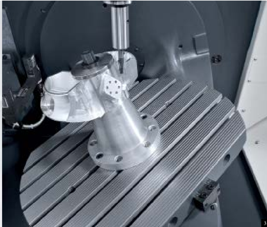
1: Гибкая обработка по 3 - 5 осям 2: Хороший обзор рабочей зоны с поставляемым по заказу инструментальным магазином 3: Стол для одновременной обработки
