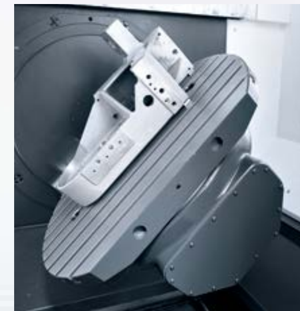
1: Цифровые приводы, линейные направляющие и системы прямых измерений (опция) обеспечивают высокую точность 2: Неподвижный стол 3: Наклонно - поворотный стол с цифровыми приводами 4: Поворотный стол с 5-осевой одновременной обработкой
